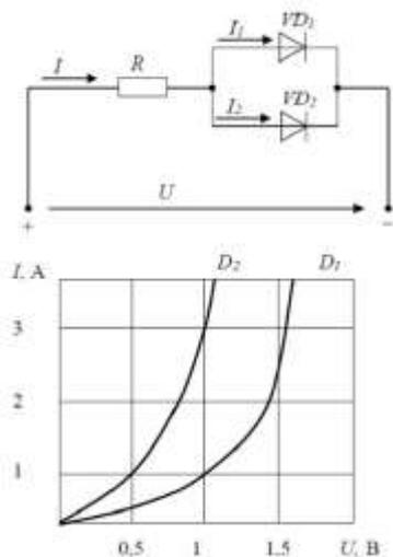
Ответ: По графику ВАХ для диода D1 определяем напряжение на нем  $U_{D1} = 1\text{В}$  при заданном токе  $I_1 = 1\text{А}$ . Затем по графику ВАХ для диода D2 определяем ток  $I_2 = 3\text{А}$ , учитывая что, напряжение на диодах D1 и D2 одно и то же. Диоды D1 и D2 включены параллельно, следовательно, суммарный ток в контуре  $I = I_1 + I_2 = 4\text{А}$ . Падение напряжения на резисторе R составит  $U_R = U - U_{D1} = 1\text{В}$ .
