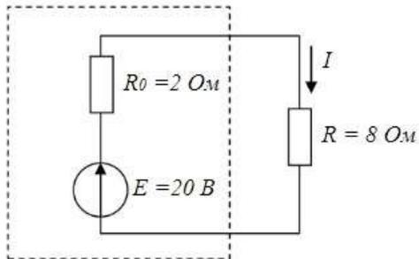
Ответ: Для расчета мощности  $W$ , выделяющейся во внутреннем сопротивлении источника ЭДС  $R_0$  определим величину тока в контуре  $I = E / (R_0 + R) = 2\text{А}$ . Мощность  $W$  равна:
