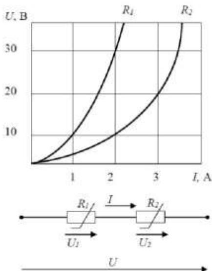
Ответ: По графикам ВАХ определяем падение напряжения  $U_1 = 30\text{В}$  на сопротивлении  $R_1$  и падение напряжения  $U_2 = 10\text{В}$  на сопротивлении  $R_2$  при заданном токе  $I_1 = 2\text{А}$ . Сопротивления  $R_1$  и сопротивления  $R_2$  включены последовательно, следовательно, напряжение  $U = U_1 + U_2 = 40\text{В}$ .
