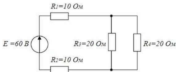
Ответ: сопротивления  $R_3$  и  $R_4$  включены параллельно и их общее сопротивление  $R_{34} = R_3 * R_4 / (R_3 + R_4) = 10\text{ Ом}$ . Сопротивления  $R_3, R_4$  и  $R_{34}$  включены последовательно, следовательно,  $R_{\text{экр.}} = R_1 + R_2 + R_{34} = 30\text{ Ом}$ .
