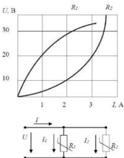
**Ответ:** По графику ВАХ для сопротивления  $R_2$  при заданном токе  $I_2 = 3\text{A}$  определяем падение напряжение  $U = 20\text{V}$ . По графику ВАХ для сопротивления  $R_1$  при напряжении  $U = 20\text{V}$  получим ток  $I_1 = 1\text{A}$ .
