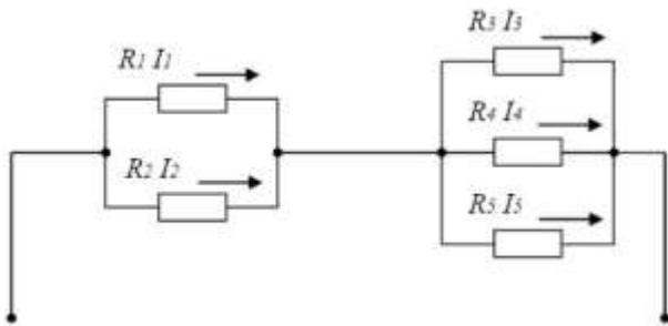
Ответ: Ток  $I$  в неразветвленной части цепи равен сумме токов  $I = I_5 + I_4 + I_3$ . Падение напряжения на резисторах  $R_3, R_4, R_5$  равно  $U = R_5 * I_5 = 40\text{В}$ . Следовательно, токи  $I_4, I_3$  по закону Ома будут равны  $I_4 = I_3 = U / R_3 = 1\text{А}$ . Суммарный ток  $I = I_5 + I_4 + I_3 = 4\text{А}$
